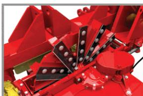
Potente rotor de 12 facas e 12 lançadores que proporciona corte preciso e excelente quebra dos grãos.
