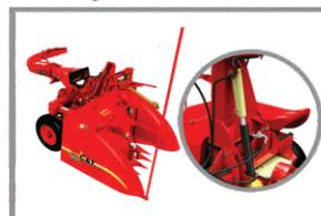
Sistema hidráulico que proporciona acesso ao rotor da máquina de forma rápida e segura.
