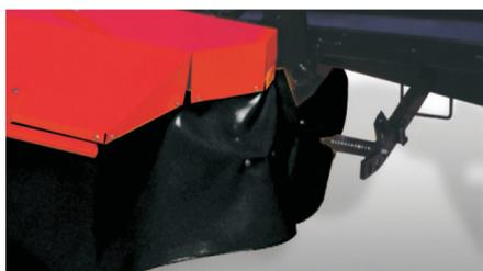
Seu dispositivo de segurança protege o equipamento contra impactos, entrando em ação automaticamente se, eventualmente a máquina chocar-se com algum tipo de obstáculo durante a operação. Quando este dispositivo é acionado a máquina articula-se para trás evitando que o impacto cause danos a segadeira.
