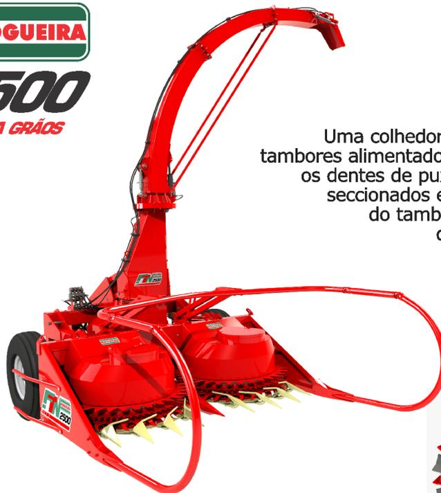
Uma colhedora que vai trabalhar com dois tambores alimentadores em uma super inovação, os dentes de puxar produtos são construídos seccionados e são parafusados por dentro do tambor, possibilitando assim troca de partes quando necessário.
