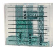
Caixa de graduação para verificar a qualidade do fertilizante
